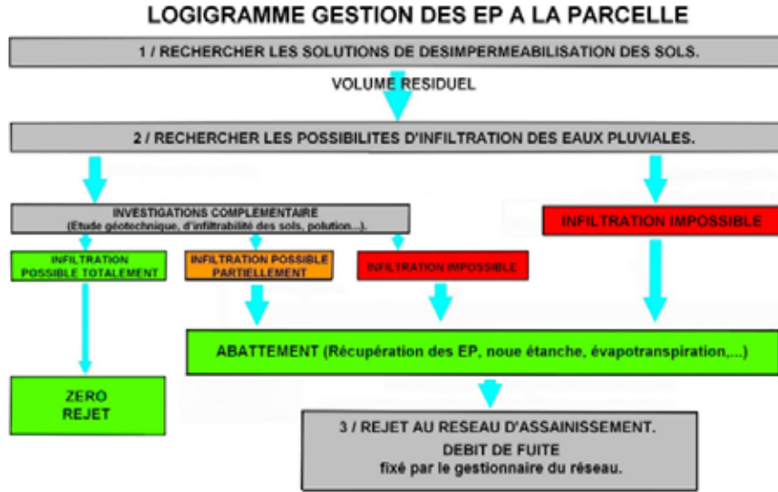
Rechercher des solutions d'infiltration des eaux pluviales : noue, bassin d'infiltration, tranchée drainante.
